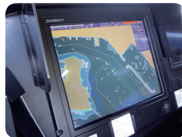
◀ 新渡輪的自動識別系統會顯示附近設有相同系統的船隻的方位和距離
